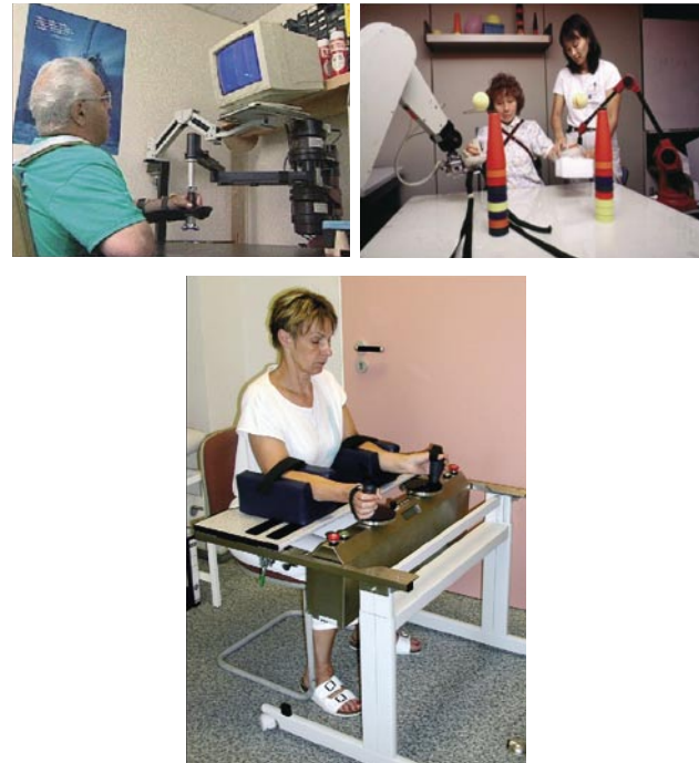
Abb. 4: Computergestützte Armtherapiegeräte, MIT-Manus (links oben), MIME (rechts oben) und BI-MANU-TRACK (unten)
